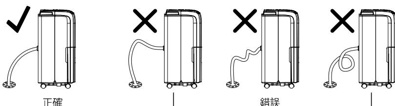
重要提示：當把除濕機放在不平的地面上或者沒有正確安裝排水管，會導致水灌滿水箱並讓機器停止運行。如果這個情況發生，請檢查除濕機的放置位置和排水管的正確安裝，為了讓機器正常的運轉，水箱一定要正確放置。
