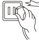
不要使電源線過分彎曲、過度拉伸、扭轉、捆扎或改造、受重物重壓或夾入；當電源線或電源插頭損壞或插座鬆動時，為避免危險，必須由我公司特約維修點或我公司售後服務部門專職人員更換。電源插頭的插片要保持清潔，電源插頭上若沾有灰塵，請仔細用乾布擦拭掉。
