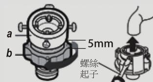
3 用十字螺絲起子略鬆開四個螺絲，以套得進水龍頭為準。再將連接器向上套上水龍頭與水龍頭靠緊後，將螺絲鎖緊，再順時針轉回螺母b部份，使ab密合，水龍頭便與連接器結合一體。
