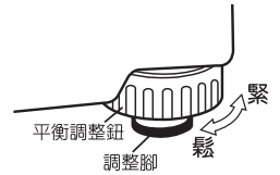
圖(三) 上側圖示調整腳操作步驟
