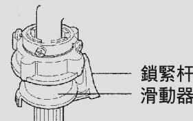
注意：請使用隨機附帶的新的進水管組件，舊的進水管組件不能重複使用。
