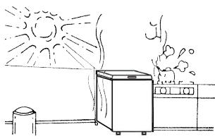
冷凍櫃避免直接受日光照射或鄰近熱的器具。(如瓦斯爐、殺蟲劑、可燃性噴霧器等)
