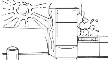
冰箱避免直接受日光照射或鄰近發熱的器具。(如瓦斯爐、殺蟲劑、可燃性噴霧器等)
