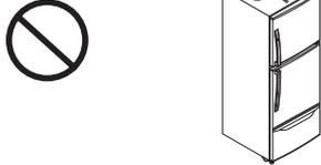
冰箱運轉時會產生震動而導致冰箱頂面物品掉落，避免水灑入有電的零部件，使絕緣損壞，造成觸電及火災的可能。
