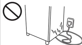
不做有損壞電源插頭和電線的事，避免電源線損傷造成漏電及發生火災。
